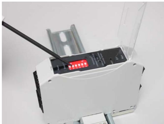
**Figure 10 : Configuration du commutateur DIP**
